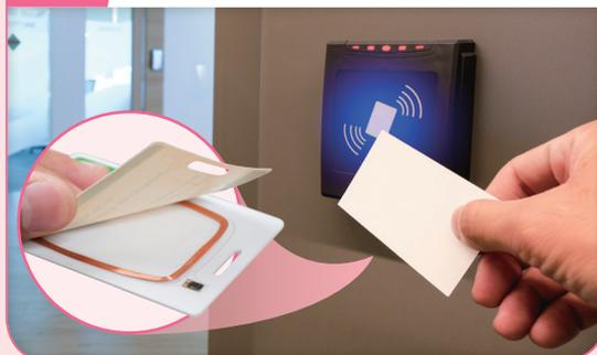
▲ 圖 3-8 RFID 運作原理。
